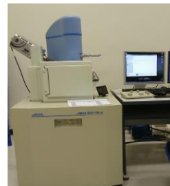
รูปที่ 10 กล้องจุลทรรศน์อิเล็กตรอนแบบส่องกราด
