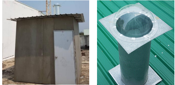
รูปที่ 1 (ก) แสดงห้องทดสอบด้านแสงสว่าง (ข) แสดงการติดตั้งท่อนำแสงจากภายนอก
