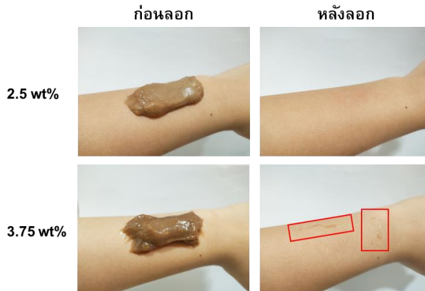
รูปที่ 5 ทดสอบการลอกออกของไฮโดรเจลที่มี TA 2.5 และ 3.75 wt%
