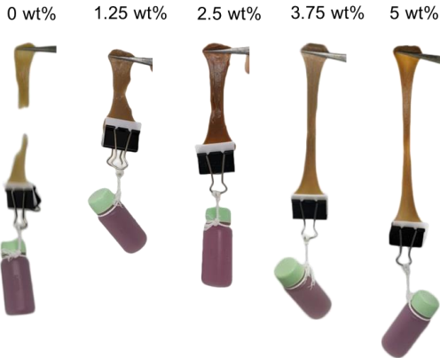
รูปที่ 3 ทดสอบความแข็งแรงของไฮโดรเจลหลังการซ่อมแซมตนเอง ณ เวลา 60 วินาที
