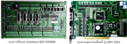
รูปที่ 12 แผงเชื่อมต่อระบบและควบคุมการเคลื่อนที่
