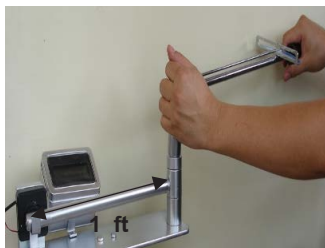
รูปที่ 8 การปรับแต่งชุดฝึกทักษะการประมาณการขันอัดแป้นเกลียวและสลักเกลียว
