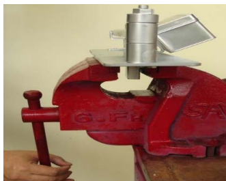
รูปที่ 7 การจับยึดชุดฝึกทักษะการประมาณการขันอัดแป้นเกลียวและสลักเกลียว
