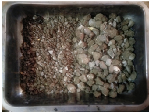
รูปที่ 2 วัสดุผิวทางเก่าที่ใช้ในการศึกษา
