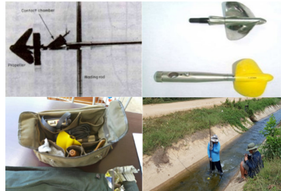
รูปที่ 3 เครื่องวัดกระแสไฟฟ้า Electric Current Meter (Propeller) [10]
