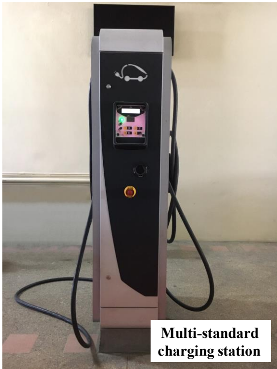
รูปที่ 7 เครื่องอัดประจุแบตเตอรี่รถยนต์ไฟฟ้าแบบรวดเร็วหลายมาตรฐานที่ได้ทำการศึกษาวิจัย
