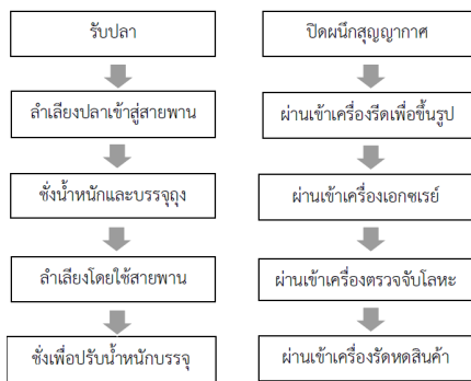
รูปที่ 1 กระบวนการบรรจุเนื้อปลาทูน่าแช่แข็ง
