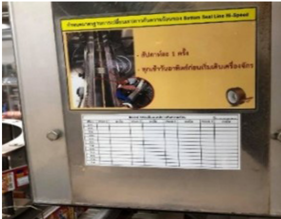
รูปที่ 15 การติดป้ายกำหนดมาตรฐานการเปลี่ยนเทปกาวกันความร้อน
