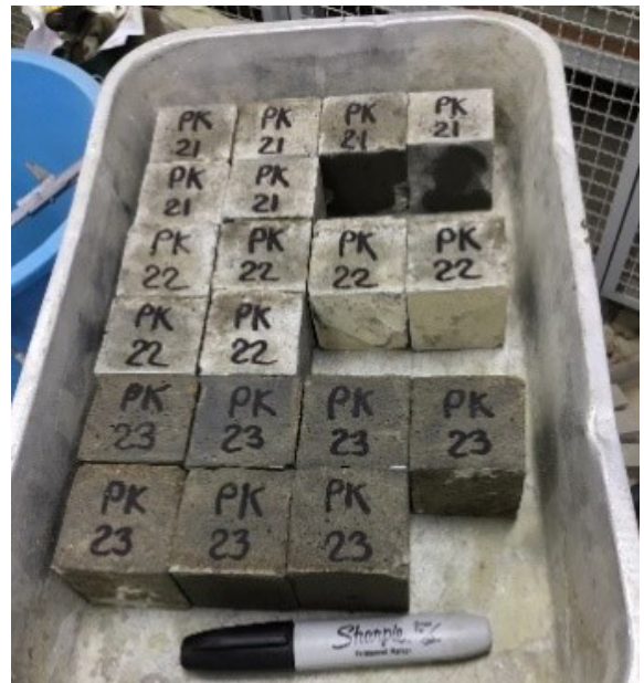
รูปที่ 1 ตัวอย่างมอร์ตาร์ปรับระดับรอการทดสอบ
