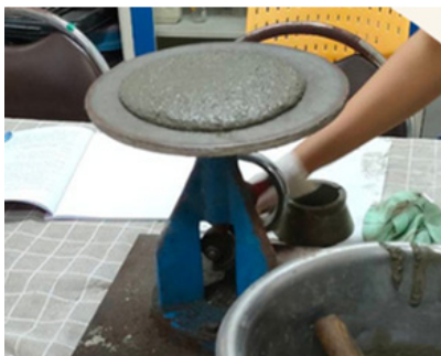
(ก) การทดสอบการไหลแผ่ของมอร์ตาร์
