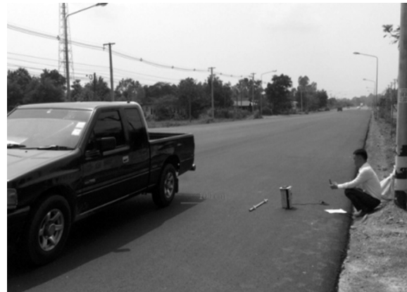
รูปที่ 4 การวัดการสั่นสะเทือนที่มีรถยนต์กำลังมีการขับผ่าน อุปกรณ์ตรวจจับสัญญาณการสั่นสะเทือน
