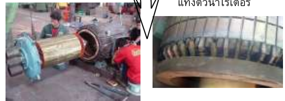
รูปที่ 1 ตัวอย่างความล้มเหลวของตัวนำสเตเตอร์และแท่งตัวนำโรเตอร์ของมอเตอร์ที่มักเกิดขึ้นในกระบวนการผลิตของภาคอุตสาหกรรม
