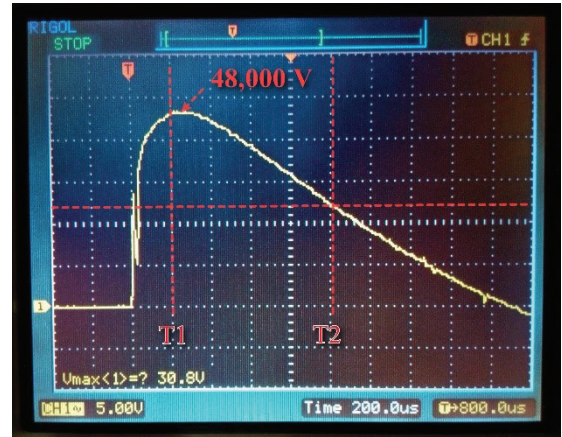
รูปที่ 13 ตัวอย่างสัญญาณของรูปคลื่นอิมพัลส์ที่จำนวนชั้นเท่ากับ 5 มีแรงดันสูงสุดเท่ากับ 48,000 โวลต์ T_1 เท่ากับ 200 ไมโครวินาที และ T_2 เท่ากับ 1,000 ไมโครวินาที
