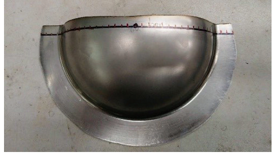
รูปที่ 16 ชิ้นงานที่ถูกผ่าเพื่อวัดการกระจายของความหนา
