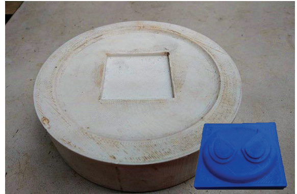
รูปที่ 12 ไล่แบบนูนต่ำและลายขึ้นรูปนูนต่ำที่ผลิตจากเทคโนโลยีพิมพ์ 3 มิติ
