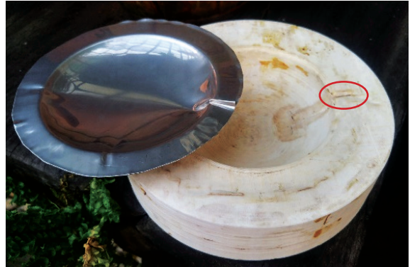
รูปที่ 1 ความเสียหายบริเวณพื้นผิวของแม่พิมพ์
