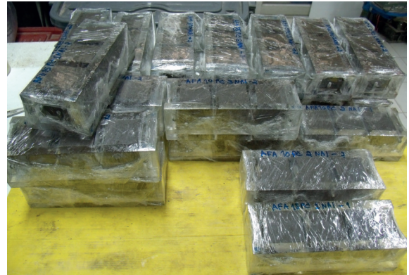
รูปที่ 1 การห่อตัวอย่างด้วยพลาสติกเพื่อป้องกันการสูญเสีย ความชื้น
