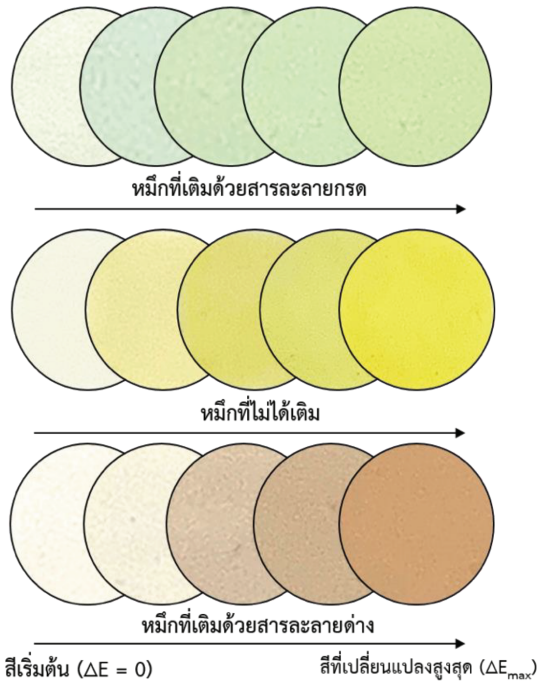
รูปที่ 3 การเปลี่ยนแปลงสีของหมึกพิมพ์และเฉดสีของหมึกพิมพ์ที่เปลี่ยนแปลงเมื่อได้รับสารละลายกรด-ด่าง (ตัวอย่างหมึกพิมพ์ที่ประกอบด้วย \text{ATQ}/\text{TiO}_2/\text{G}/\text{CbB} = 25/100/100/100 ส่วนต่อหนึ่งร้อยส่วนสารย้อม)
