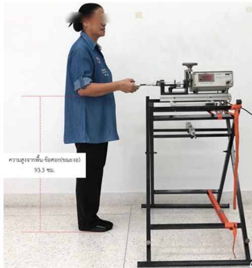
รูปที่ 6 ลักษณะการออกแรงบิดทำยืนที่ระดับความสูงของ ลูกบิดประตู 1,000 มิลลิเมตร
