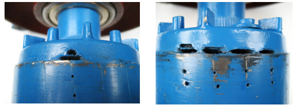
(ก) โรเตอร์แตกหัก 1 แท่งตัวนำ (ข) โรเตอร์แตกหัก 4 แท่งตัวนำ รูปที่ 3 การดัดแปลงให้ตัวนำโรเตอร์แตกหัก
