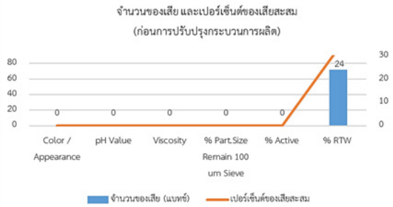
รูปที่ 3 จำนวนของเสียที่เกิดจากกระบวนการผลิตสารออกฤทธิ์ชนิดแคปซูล (ก่อนการปรับปรุง)
