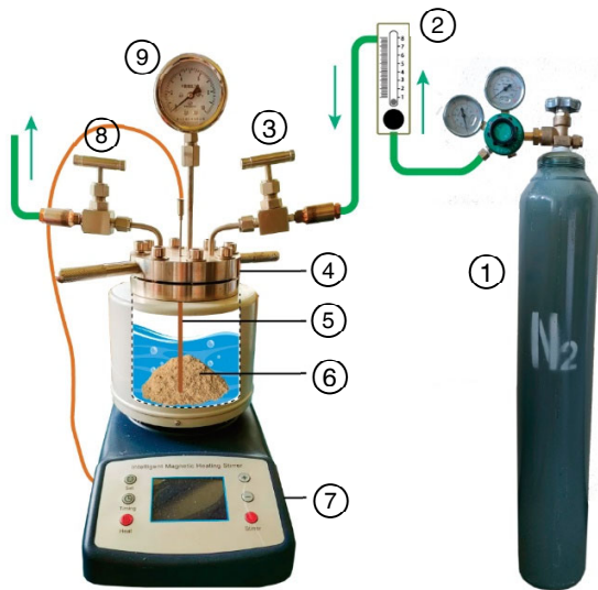
(1) ถังแก๊สไนโตรเจน (2) เครื่องควบคุมอัตราการไหล (3) วาล์วทางเข้าแก๊ส (4) ปฏิกรณ์สแตนเลส (5) เทอร์โมคัปเปิล (6) ผงชีวมวล (7) ระบบควบคุมอุณหภูมิ (8) วาล์วทางออกแก๊ส (9) เกจความดัน
